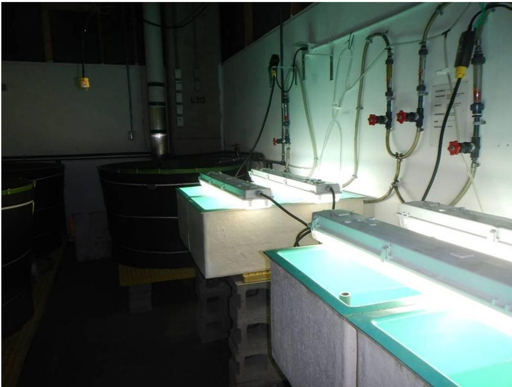
Figure 23. Montage complet des 4 bassins utilisés pour la production de zostère, alimentation en eau salée, oxygène et éclairage à l'aide de 2 combos de néon 6 500 K et de 4 100 K par bassin.
