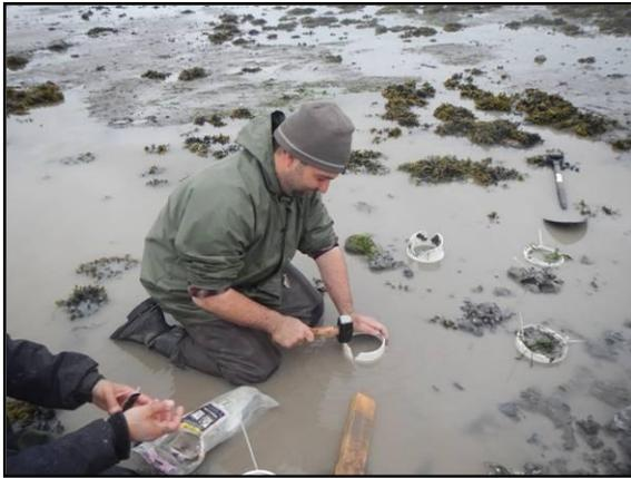
Figure 18. Enfoncer un tuyau de 5'' de diamètre dans les sédiments silto-sableux à l'aide d'un maillet.
