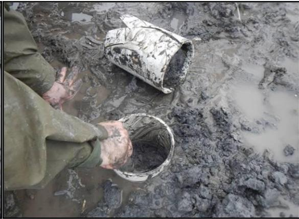
Figure 19. Retirer les sédiments à l'aide d'une truelle.
