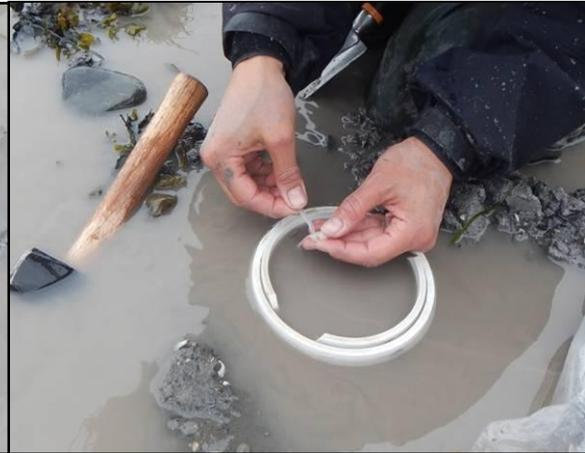
Figure 17. Joindre les deux tubes avec des attaches autobloquantes.
